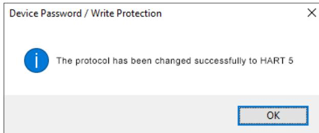
**ACHTUNG!** Nach der Umstellung auf HART 5 wird die Konfiguration auf die Werkseinstellung zurückgesetzt.
